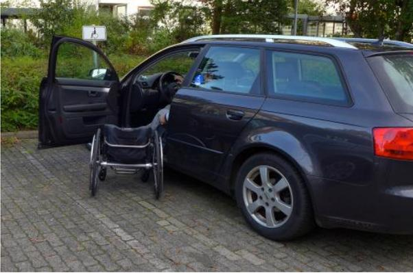
Mit 750 cm Länge kann auch ein Fahrzeug mit der Türöffnung hinten gut be- und entladen werden.
